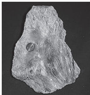
図5 トロナ; 鉱物(炭酸塩鉱物)の一種 \text{Na}_3\text{H}(\text{CO}_3)_2 \cdot 2\text{H}_2\text{O} , または \text{Na}_3(\text{CO}_3)(\text{HCO}_3) \cdot 2\text{H}_2\text{O} , または \text{Na}_2\text{CO}_3 \cdot \text{NaHCO}_3 \cdot 2\text{H}_2\text{O}
